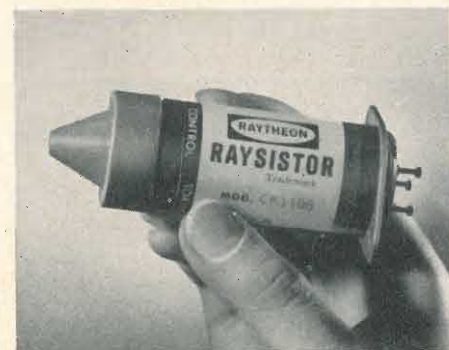
Progettato per controllare apparecchiature a raggi X e genericamente ad alta tensione, questo componente presentato dalla RAYTHEON Co. è basato su un sistema elettro-ottico. Il dispositivo è racchiuso in un fluido dielettrico trasparente e può lavorare fino a 25 kV.
