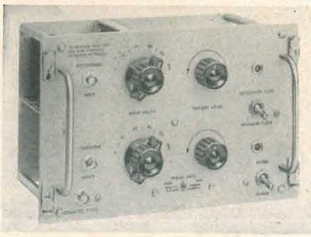
Una nuova unità inseribile nei contatori elettronici 524B/C/D e che consente la misura di angoli di fase con precisione che raggiunge \pm 0,1^\circ è stata recentemente messa a punto dalla HEWLETT PACKARD Co. L'unità, mod. 526D, permette di misurare anticipi o ritardi tra gli angoli di fase di due segnali aventi frequenza compresa tra 1Hz e 20 kHz.
